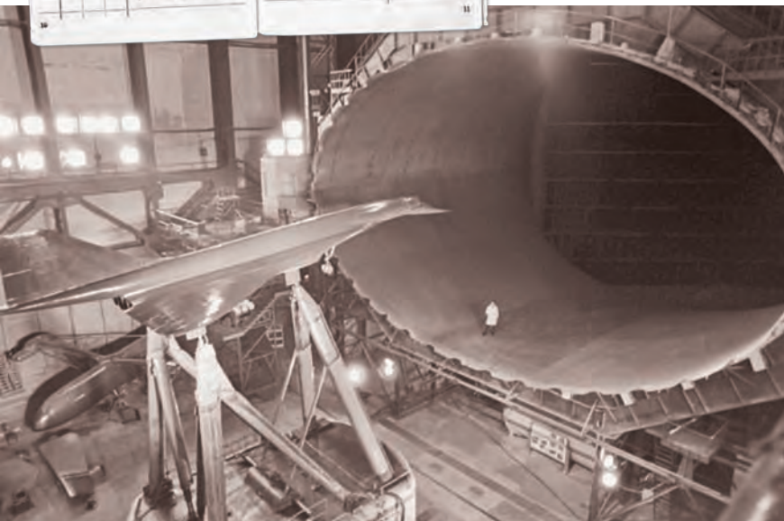
Испытания сверхзвукового пассажирского авиалайнера Ту-144 в аэродинамической трубе. ЦАГИ
