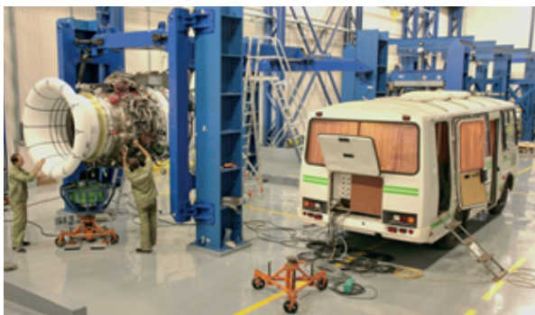
Рис. 1. Проведение выездных ЧИ авиационного двигателя с использованием передвижной виброизмерительной лаборатории ЦАГИ
