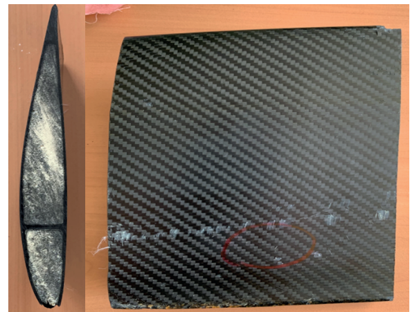
Рис. 6. Образец, вырезанный из регулярной части малогабаритной лопасти тянущего винта из углепластика с пенопластовым наполнителем и подкрепляющим элементом (лонжероном)
