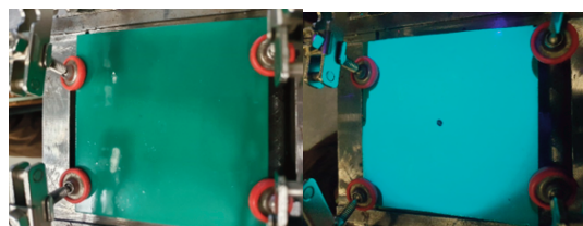
Рис. 1. Визуализация ударного повреждения углепластикового образца, окрашенного полиуретановой эмалью, с нанесенным УИП при обычном (а) и ультрафиолетовом (б) облучении
