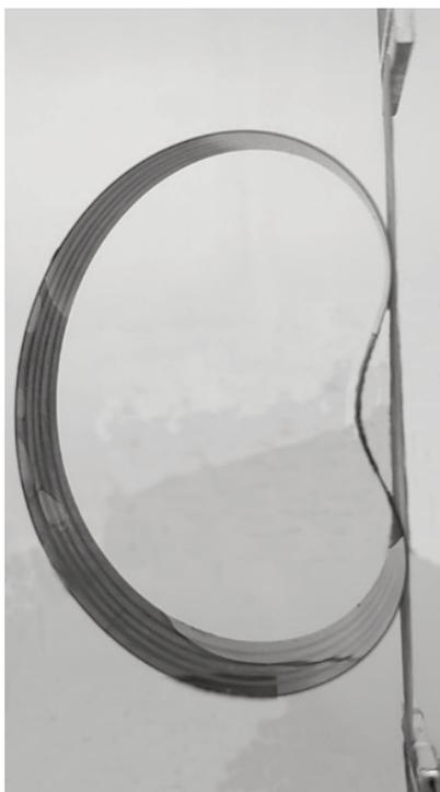
Рис. 1. Форма потери устойчивости изотропного лайнера при намотке системы нитей
