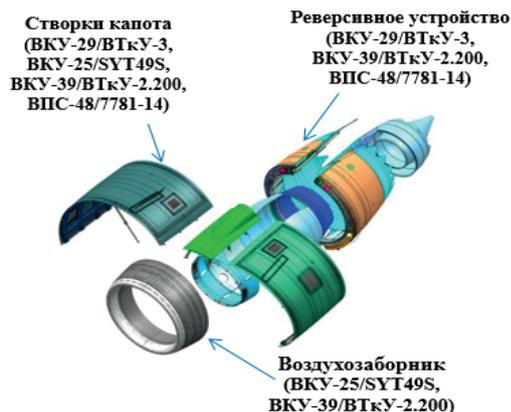
Рис. 3. Мотогондола двигателя ПД-14
