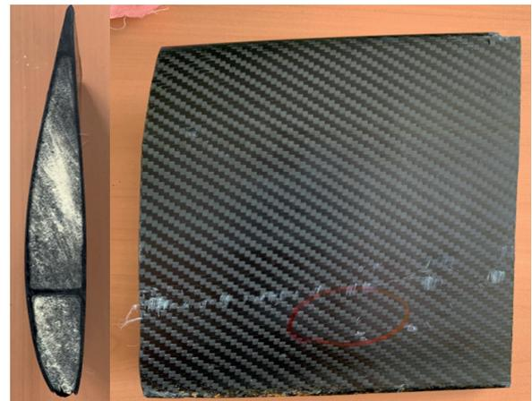
**Рис. 6.** Образец, вырезанный из регулярной части малогабаритной лопасти тянущего винта из углепластика с пенопластовым наполнителем и подкрепляющим элементом (лонжероном)
