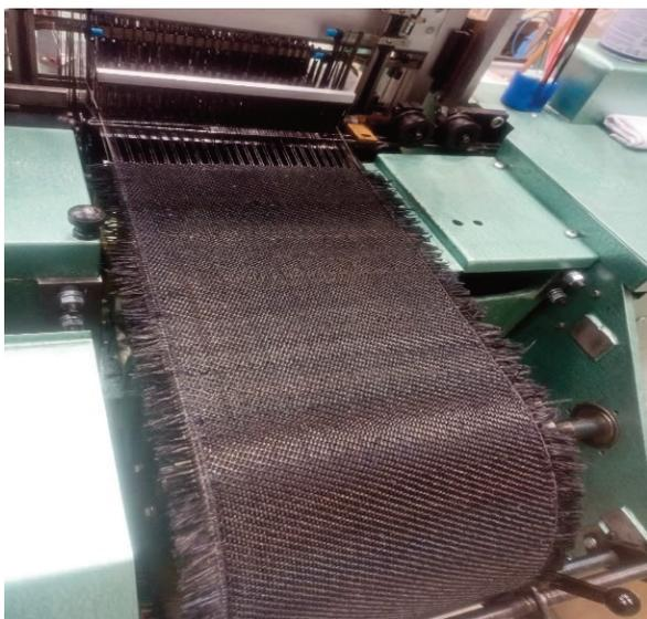
Рис. 2. Процесс изготовления SiC-ткани
