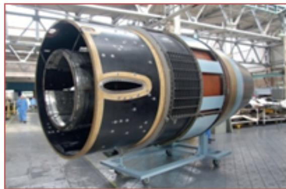
Рис. 2. Реверсивное устройство двигателя ПС-90А
