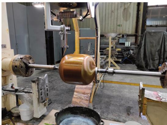
Рис. 2. Процесс намотки металлокомпозитного баллона
