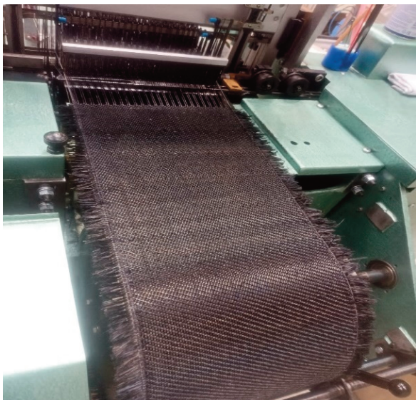
Рис. 2. Процесс изготовления SiC-ткани
