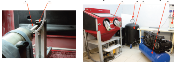
Рис. 5. ПЭУ со сверхзвуковым соплом: 1 – весы; 2 – компрессор; 3 – ресивер; 4 – манометр; 5 – пылезащитная камера; 6 – исследуемый образец; 7 – сверхзвуковое сопло
