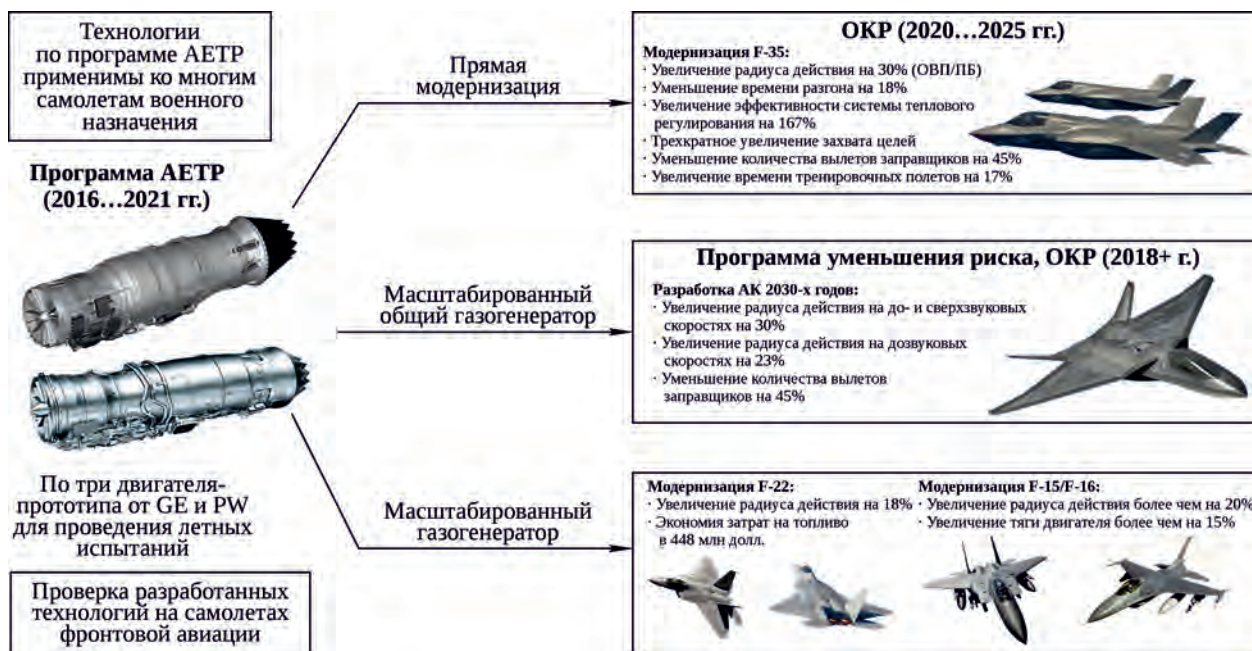
Рис. 11. Возможные улучшения характеристик самолетов фронтовой авиации при применении технологий, разработанных по программе АЕТР [60]
