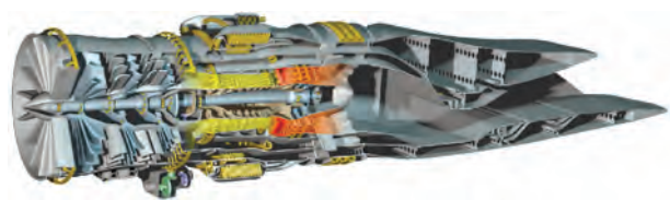
Рис. 10. Трехконтурный двигатель компании General Electric в разрезе [59]
